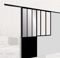
V40 sur allège + traverses + plats à coller + porte suspendue 40 kg avec plats à coller
